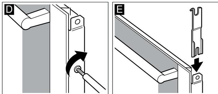
7. Abdeckung aufsetzen und anschrauben. Lässt sich die Abdeckung nicht anschrauben, prüfen ob die Scheiben richtig in der Halterung sitzen.
