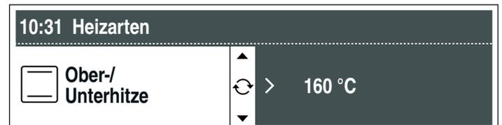
2. Mit Taste zur Temperatur wechseln und mit dem Drehwähler die Temperatur einstellen.
